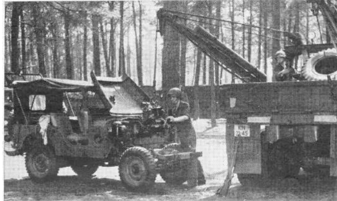
Soldaat Hoogsteen plaatst een nieuwe motor in een jeep
