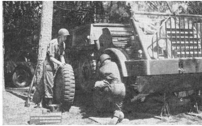
Werkzaamheden aan de voorbrug van de YA 328
