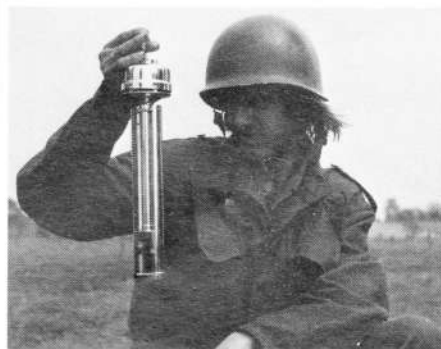
Kanonnier J. M. Leenders meet temperatuur en vochtigheid met behulp van een instrument, dat een zogenaamde droge en natte bol bevat...
